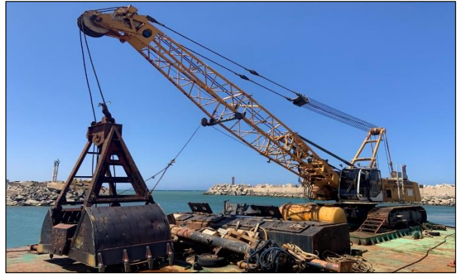
Figure 10 : Photo représentant la grue utilisée pour le prélèvement
