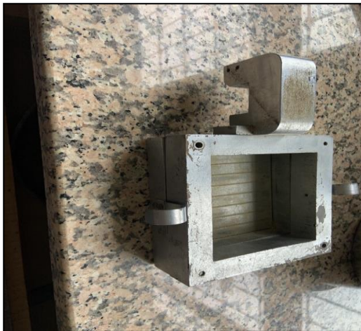
Figures 30 : La boîte de cisaillement 10/10 cm et le bâti de chargement
