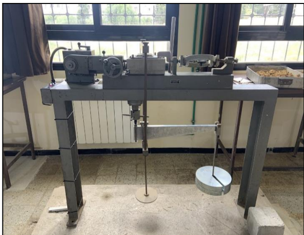
Figures 30 : La boîte de cisaillement 10/10 cm et le bâti de chargement
