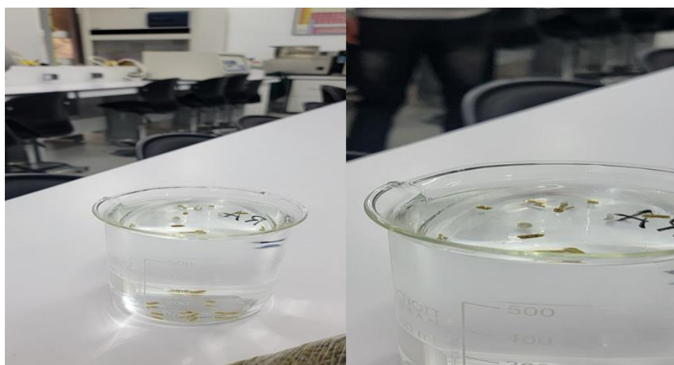
Figure 8 : Essai de flottabilité des granulés expérimentaux
