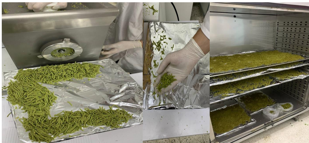
Figure 6 : Granulation et séchage des granulés expérimentaux de l'aliment
