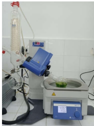
Figure 20:Evaporation du solvant par un rota-vapeur.
