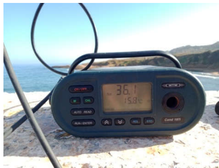
Figure 6 : Instrument de mesure de la salinité et conductivité de terrain.
