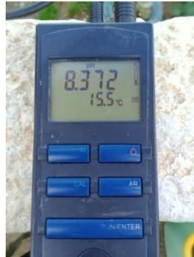
Figure 5 :Valise multiparamètres terrain (mesure pH et température).
