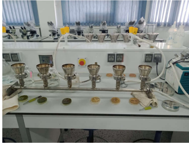
Figure 12 : Un dispositif de filtration sous vide de marque Sartorius.
