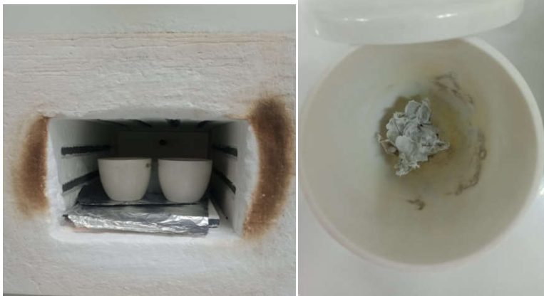
Figure 16 : Creusets contenant l'algue Figure 17 : Creusets contenant la matière minérale Séchés dans le four à moufle à 600°C
