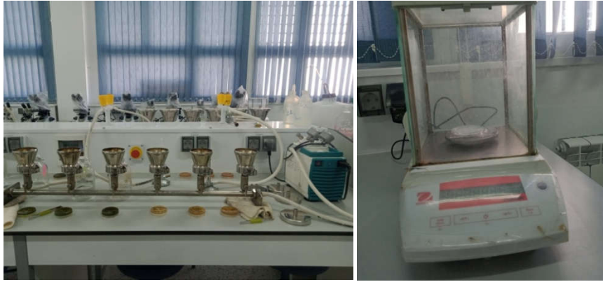
Figure 10 : Une rampe de filtration sous vide de marque Sartorius Figure 11 : Une balance de précision Sartorius
