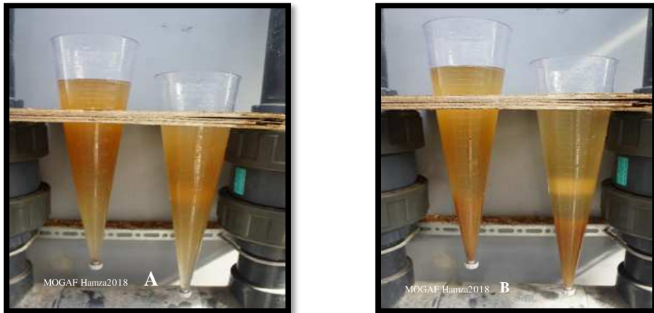
Figure 36 : photo représente des cônes d'Imhoff, (A) avant la décantation, (B) après la décantation.
