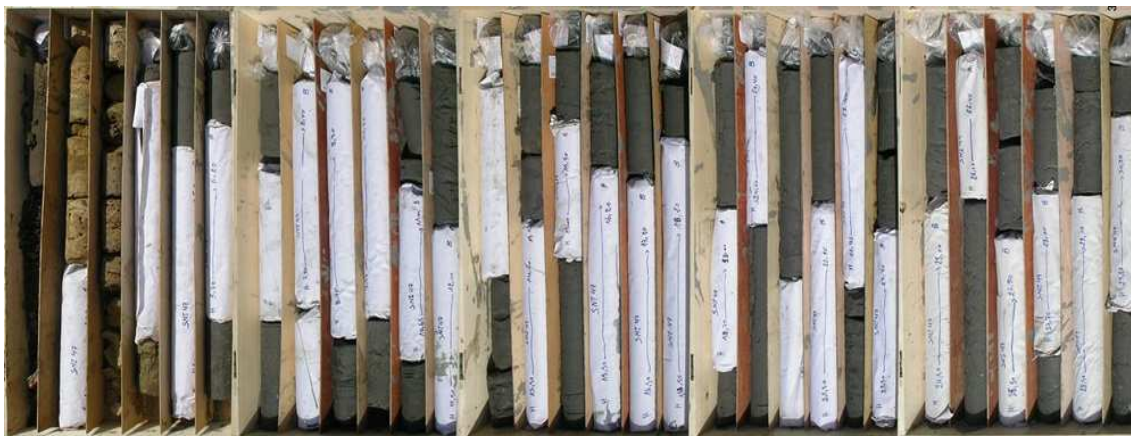
Figure 10 : Photo montrant des carottes de l'argile, et de marnes du Plaisancien, (Sc06 sur la coupe AA') [JICA, 2006].
