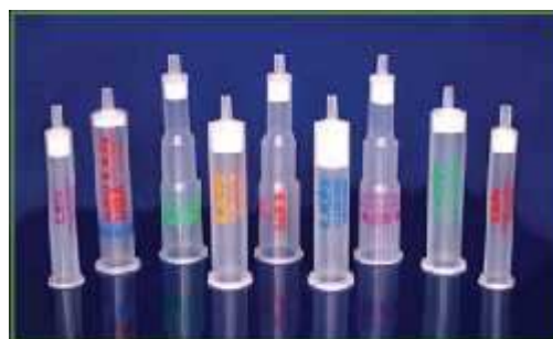
Figure 2: les deux différentes cartouches à droite le solide adsorbant à gauche la superposition de disques ( www.scpscience.com )
