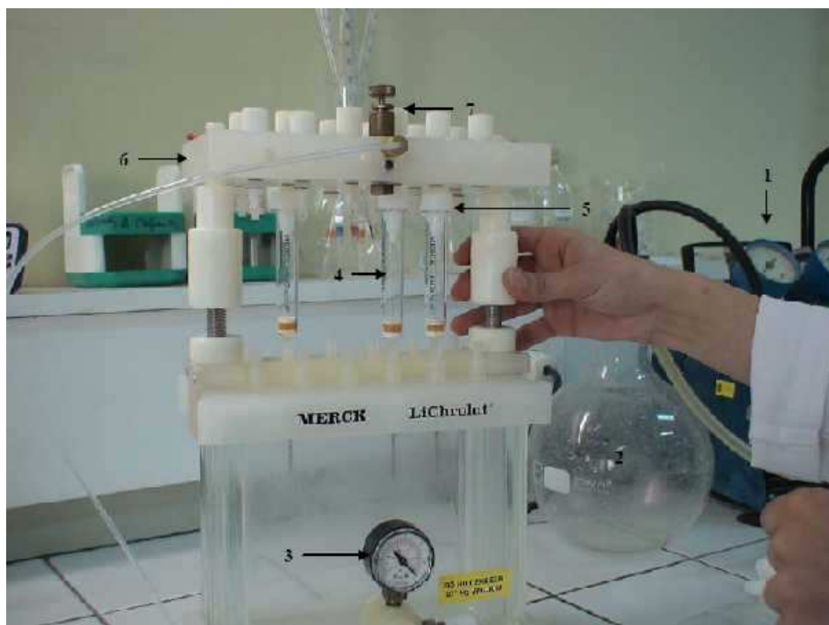
Figure 5 : photo du dispositif SPE utilisé ; pompe électrique (1), réservoir de déchet (2), le manomètre (3), cartouche (4), adaptateur (5), unité de séchage (6), vanne de contrôle du flux d'air (7)
