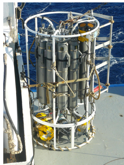
Figure 17 : Rosette utilisée avec 11 bouteilles Niskin, CTD, ADCPs, Altimètre et UVP
