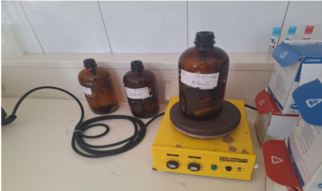
Figure 5: Bouteille BODTrak (DBO5)
