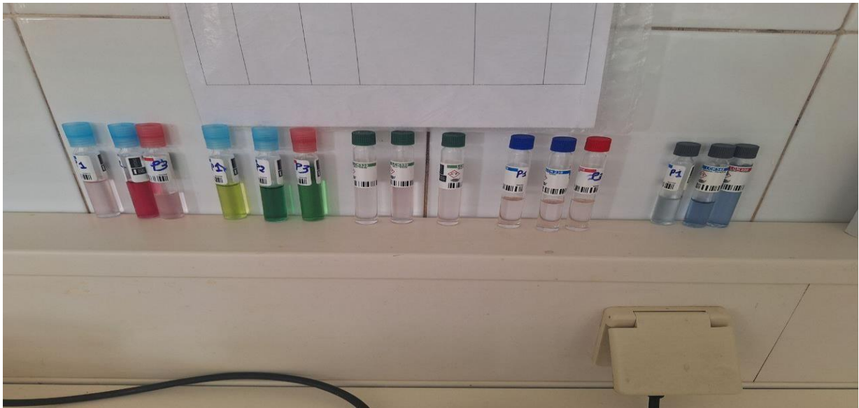
Figure 18: Tubes LCK (des formes azotées)
