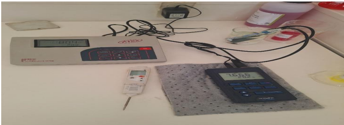
Figure 4: conductimètre+ pH-mètre+ thermomètre.
