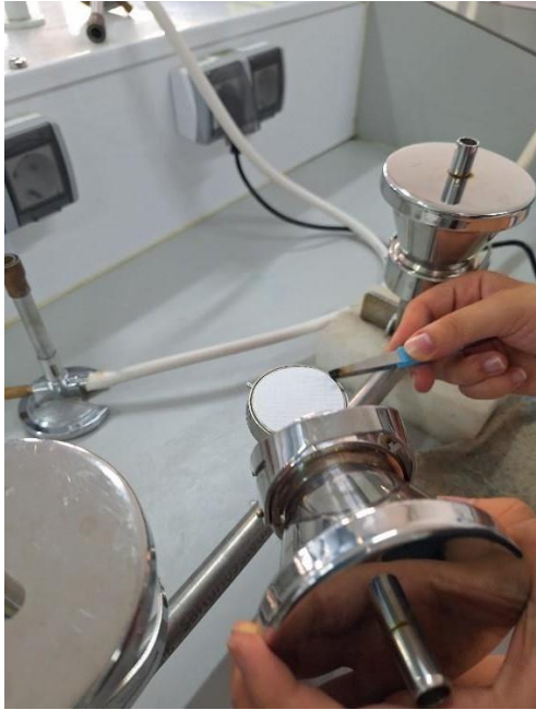
Dépôt de filtre sur la rampe de filtration
