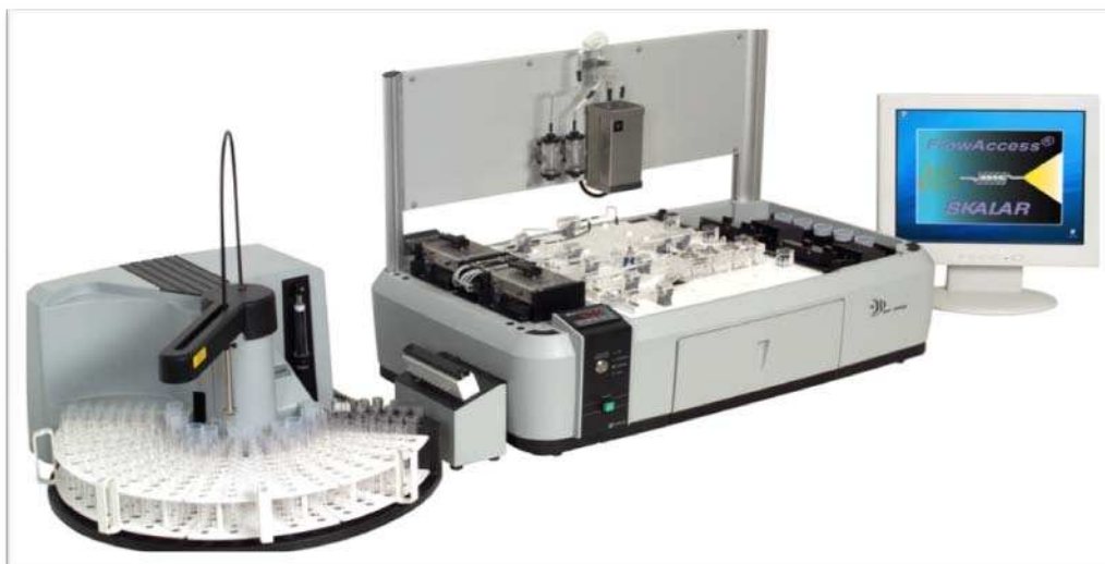
Figure 07. L'Auto Analyser San Plus (SKALAR ® , 1998) ( www.skalar.fr/prsan.htm )
