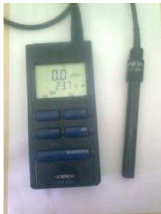
Figure 05 : un conductimètre marque WTW type «Cond 315i /Set»
