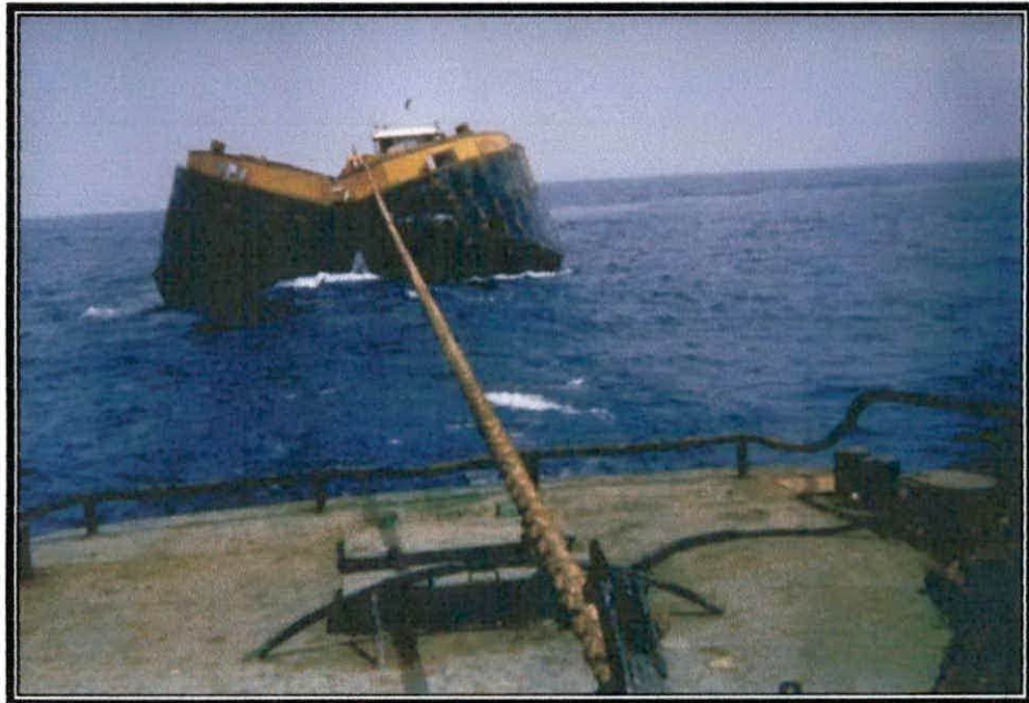
Photo N°7 : Ouverture totale du clapet et déversement des produits dragués.
