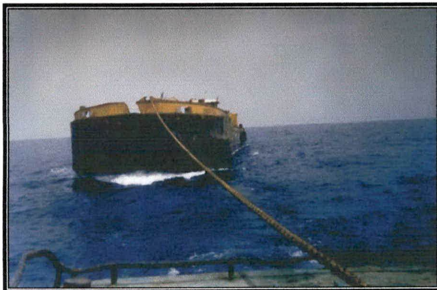
Photo N° 6: début d'ouverture des clapets du chaland.
