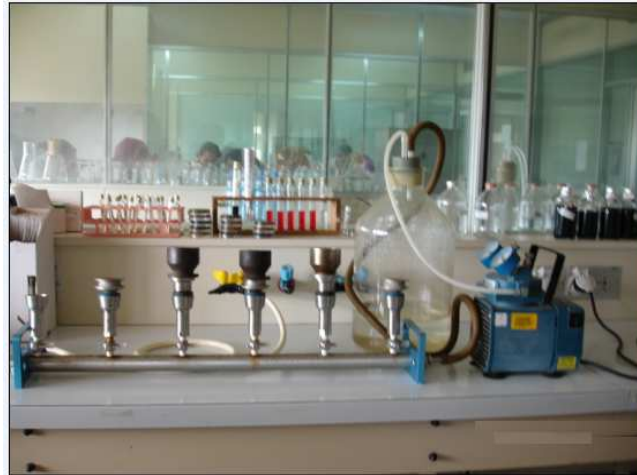
Figure 12 : Dispositif de l'appareil de filtration sur membrane.
