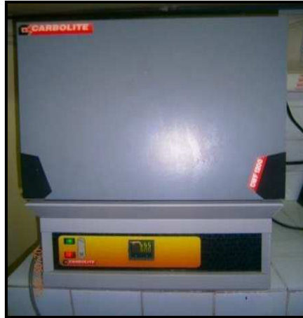
Figure II.8 : Four à moufle. Carbolite CWF 1200.
