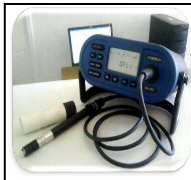
Figure II.5 : Conductimètre de terrain.
