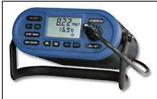
Figure II.4 : Oxymètre de terrain.
