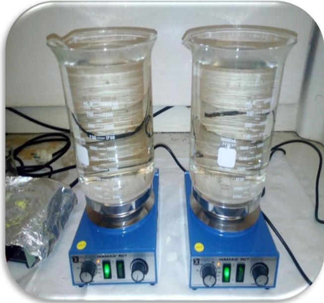
Figure iv : Evaporation d'eau de pluie par une plaque chauffante.
