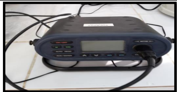
Image de sondes de terrains marque WTW type cond 197i
