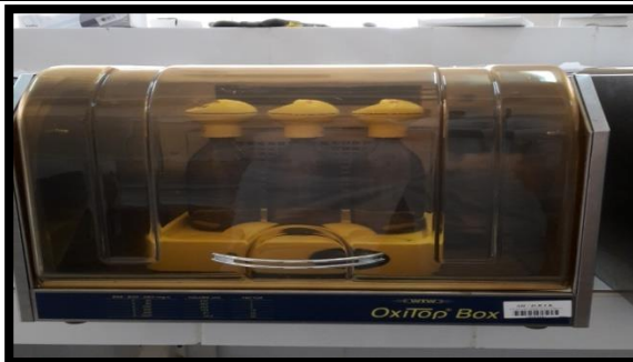
Image du dispositif de mesure du DBOs de marque WTW type OxiTop ®
