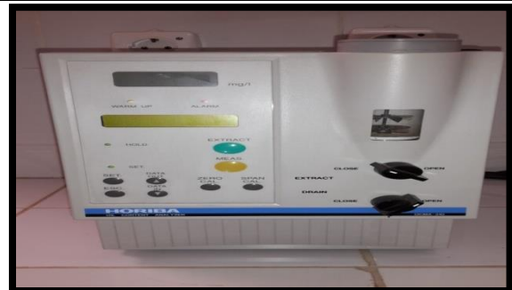
Image de dispositif de marque HORIBA type OCMA-310.
