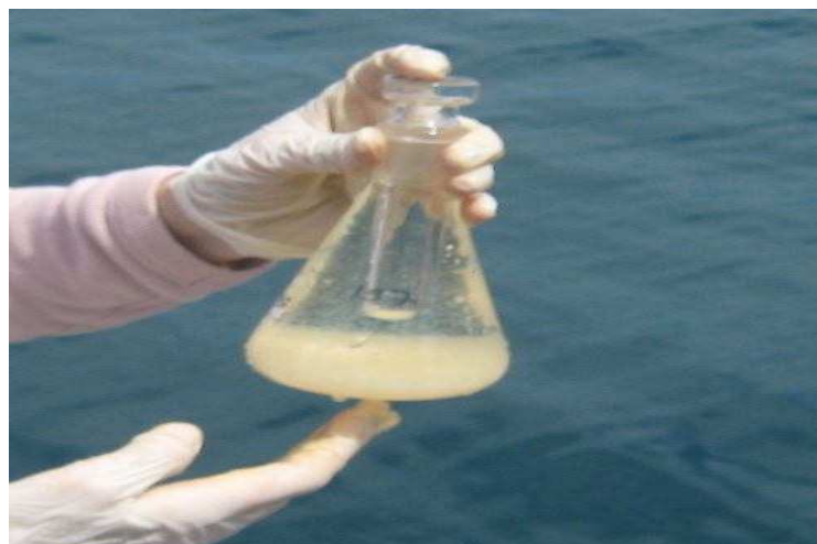
Figure 3-3 : Echantillonnage de l'oxygène dissous, et aspect du flacon après fixation.
