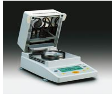
Figure 14 : dessiccateur infrarouge de marque SARTORIUS MA 45. ( https://www.laboandco.com/analyseur-dhumidite-dessiccateur-infrarouge-sartorius-ma37-sartorius-SAR-MA371 )
