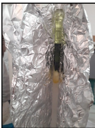
Figure II.11 : Colonne de chromatographie de gel de silice pour la séparation des pigments.
