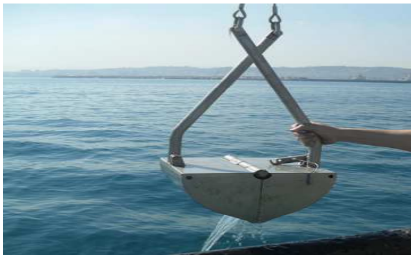
Figure III.2 : une benne preneuse métallique de 5 kg.
