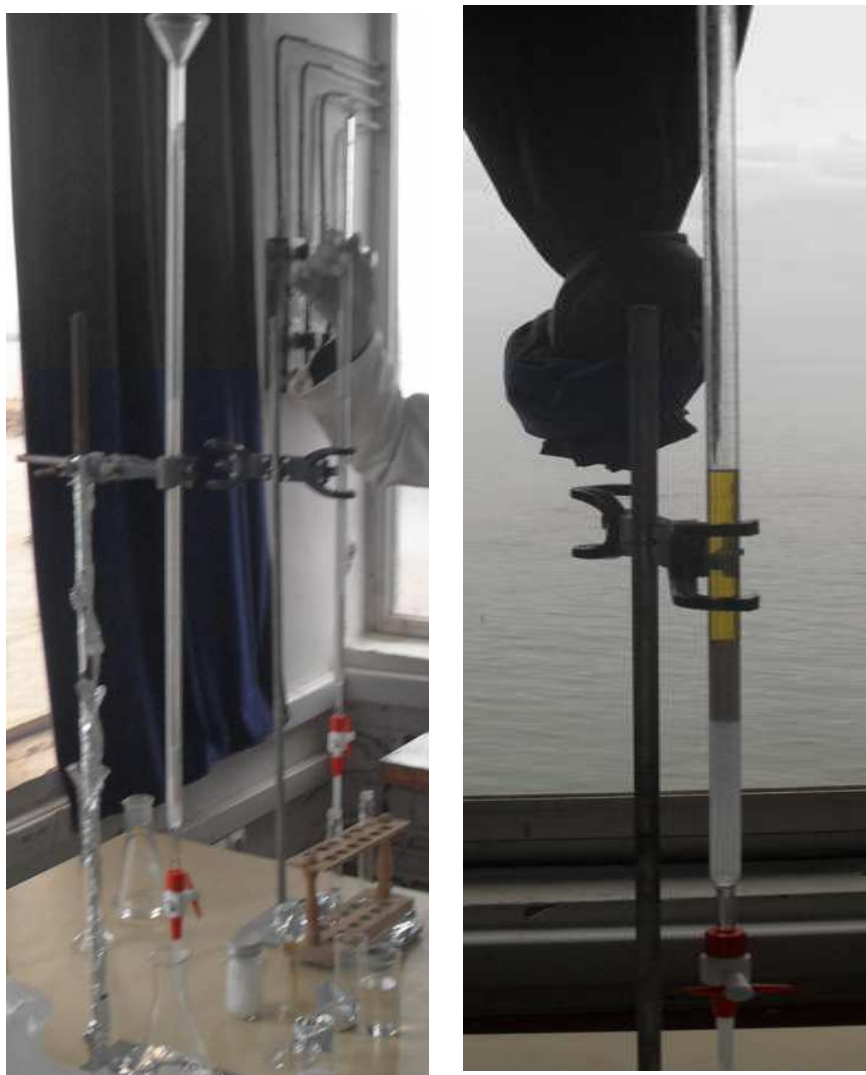
Figure III.9 : Une colonne de Purification et séparation
