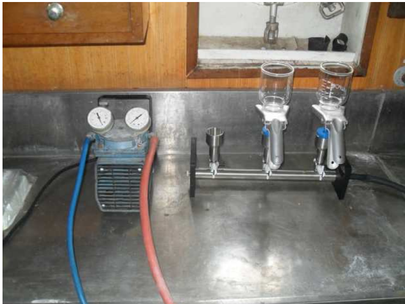
Figure III.6 : Dispositif de filtration (bouteille de filtration, pompe sous vide).
