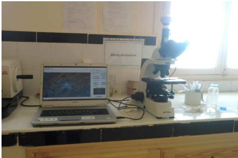
Figure 04 : Microscope photonique type OPTIKA B 500, avec camera numérique MA88-300 placée par un câblé avec un micro portable utilisé dans cette étude.
