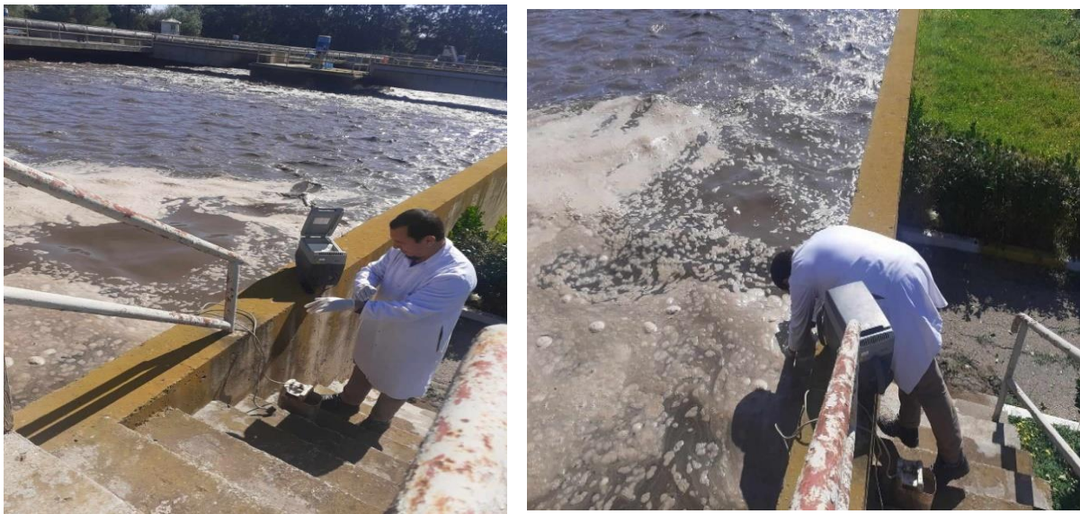
Figure 10: Prélèvement d'eaux usées à partir du bassin d'aération de la STEP de Chenoua
