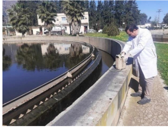
Figure 11: Prélèvement d'eaux usées à partir du décanteur secondaire de la STEP de Chenoua
