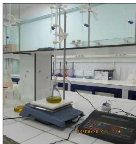
Figure 14 : Titrage, Tashiro et Ph mètre.
