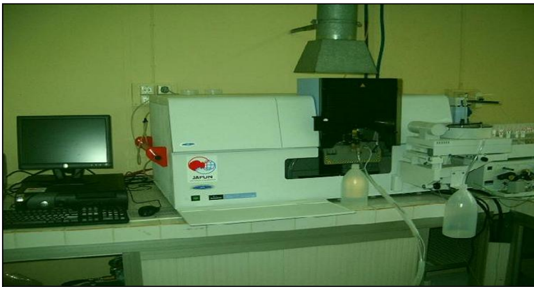
Figure 6 : Spectrophotométrie d'Absorption Atomique Perkin Elmer® AAnalys 700.
