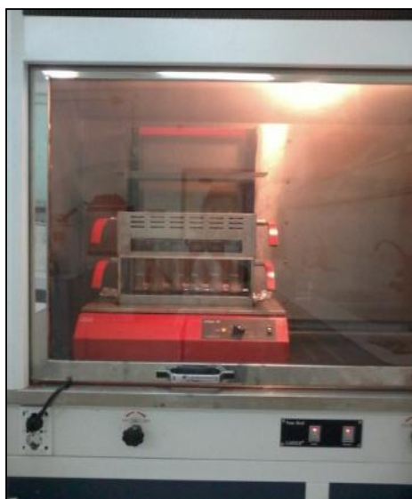
Figure 11 : Appareil de minéralisation.
