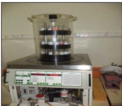
Figure 1 : Lyophilisateur (CHRIST BETTA 1-8). Figure 2 : Broyage a l'aide d'un mixeur.
