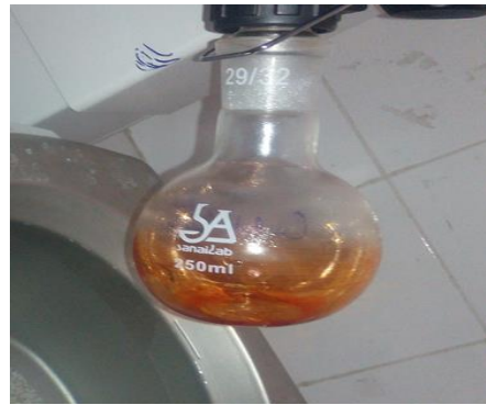
Figure 1 : Lipides et les pigments extraits par la méthode de soxhlet
