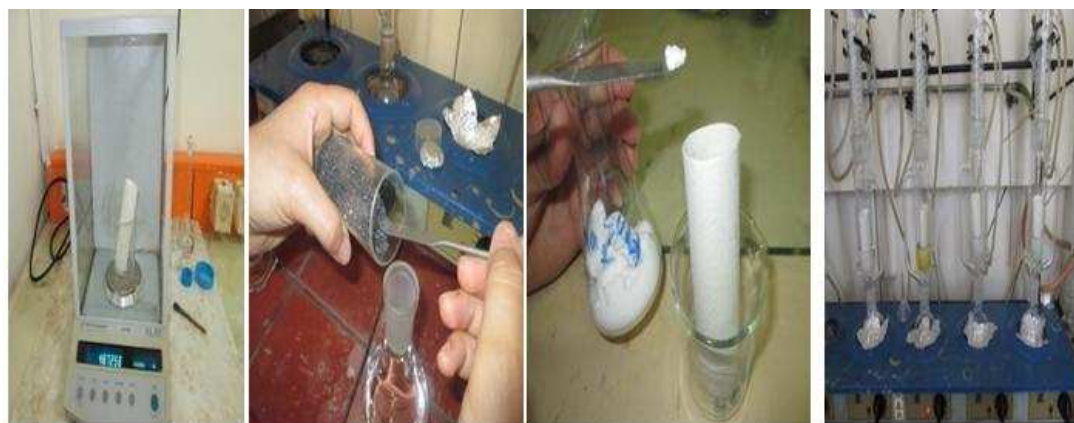
Figure 20 : étapes d'extraction des hydrocarbures dans le sédiment
