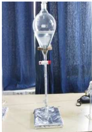
Figure 18: Dispositif d'extraction des hydrocarbures dans l'eau.
