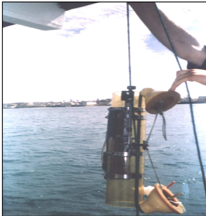
Fig.6 : Bouteille de prélèvement à clapets de type "Von Dorm".
