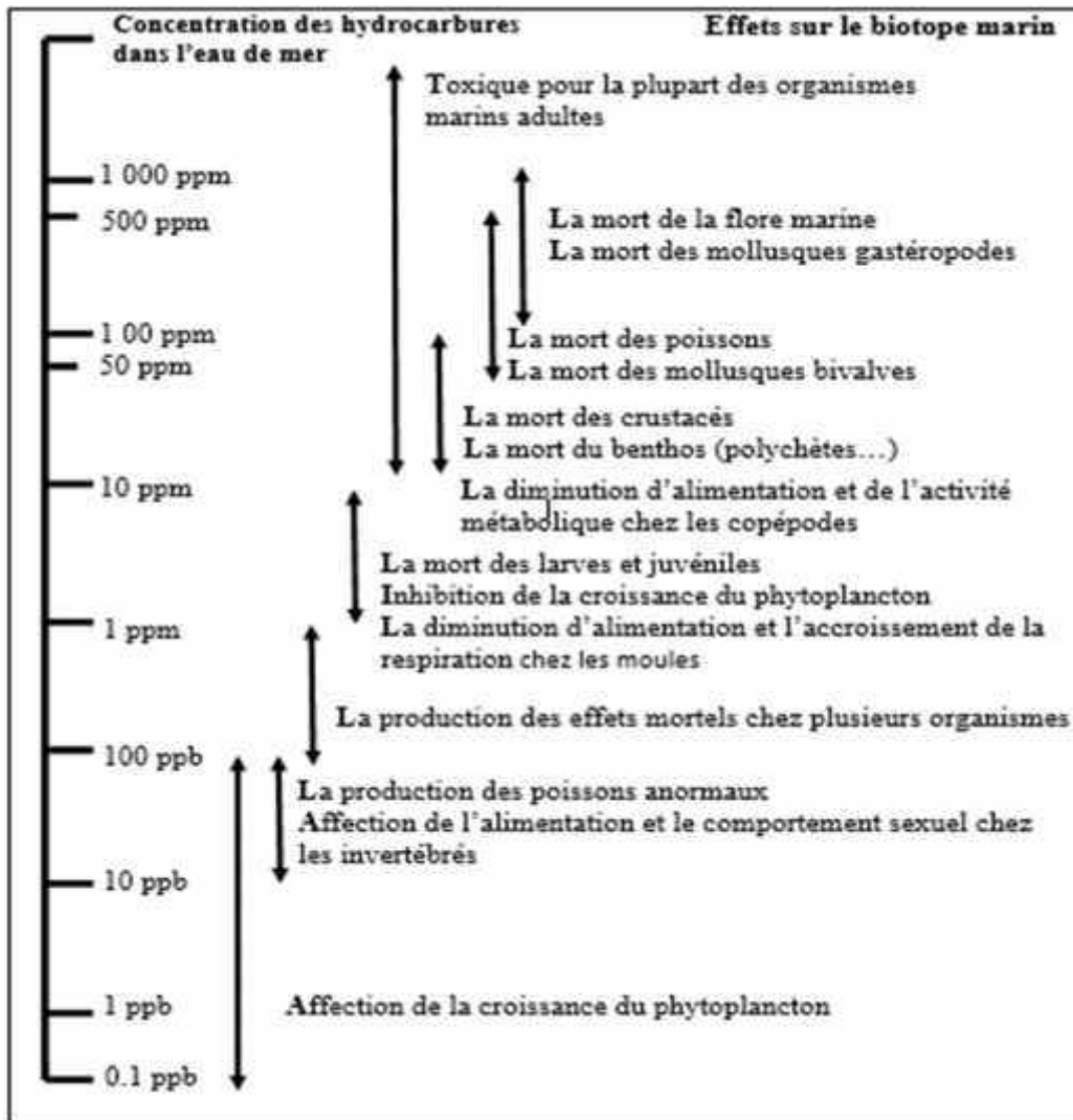
Figure 3: La description schématique de susceptibilité des organismes marins aux hydrocarbures suivant leurs concentrations (en particulier les hydrocarbures aromatiques soluble) (O'Sullivan et Jacques, 2001 in Bocard, 2006)
