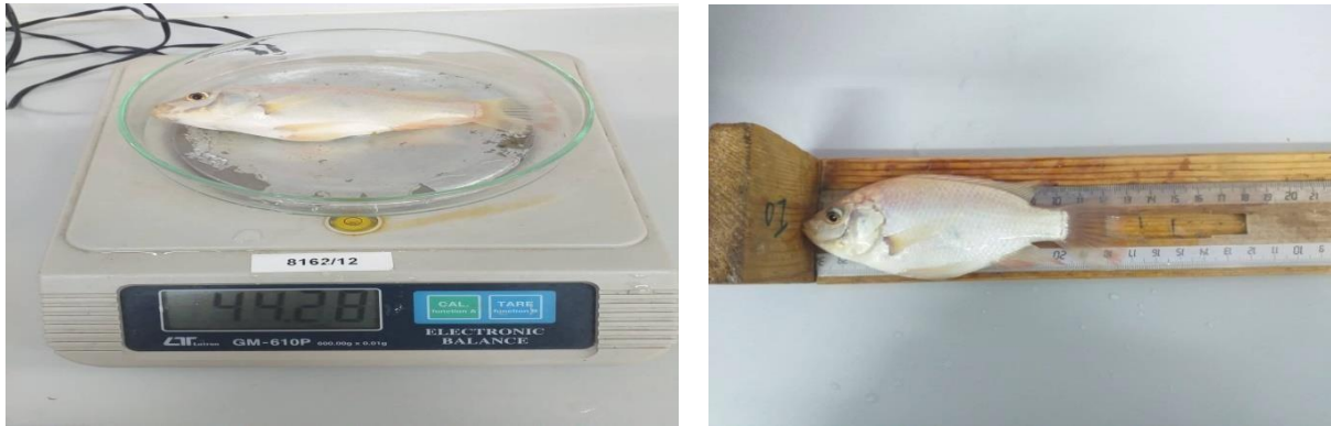
Figure II. 7: Balance électronique (à gauche), ichtyo mètre (à droite) pour les mesures en poids et en taille des alevins.
