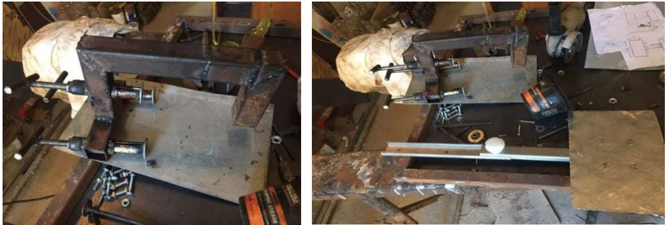
Figure IV.15: Fabrication du support écho-optique.
