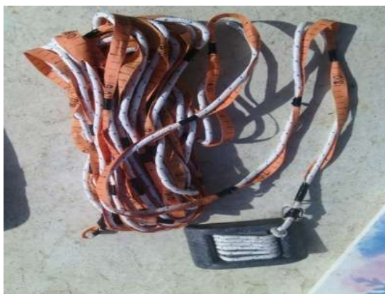
Figure III.1: Corde graduée liée à un plomb
