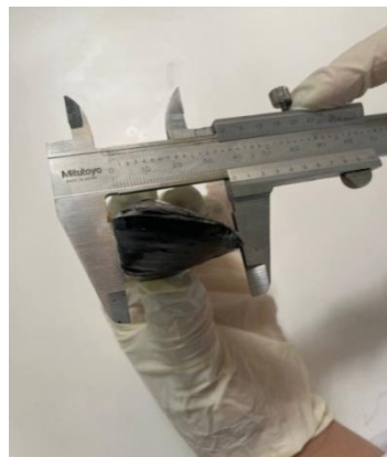
Figure 11: mesure de la longueur (L)
