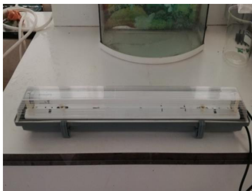
Figure II.16 : Lampe néon ( PHILIPS TL-D 18W/546765 ) utilisée comme source artificielle de lumière
