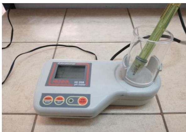
Figure II.14: pH mètre de (type HI 208 )
