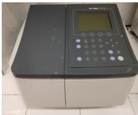
Figure II.17 : Spectrophotomètre (type UV-1800 SHIMADZU ) utilisé pour la mesure de la DO
