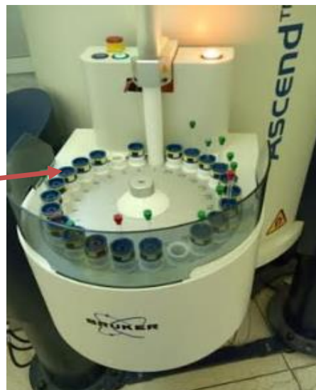
Figure 35 : Port-échantillons de l'appareil RMN. Photo prise le 20/01/2021
