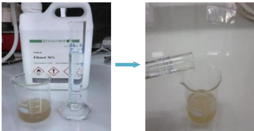
Figure 30 : Récupération du jus de carbonatation et ajout de l'éthanol. (Photos prises le 25/11/2020).
