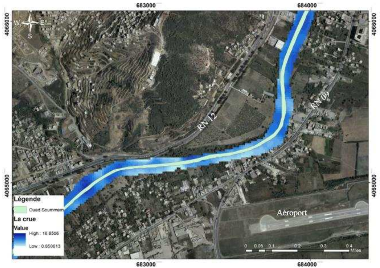
Figure III.22 : Résultats de la simulation de la crue d'Oued Soummam dans la zone 02
