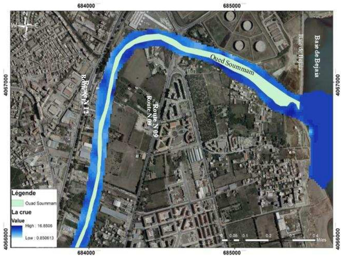
Figure III.21 : Résultats de la simulation de la crue d'Oued Soummam dans la zone 01
