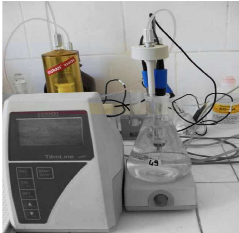
Figure 9: Titrateur automatique et montage pour la mesure d'alcalinité totale
