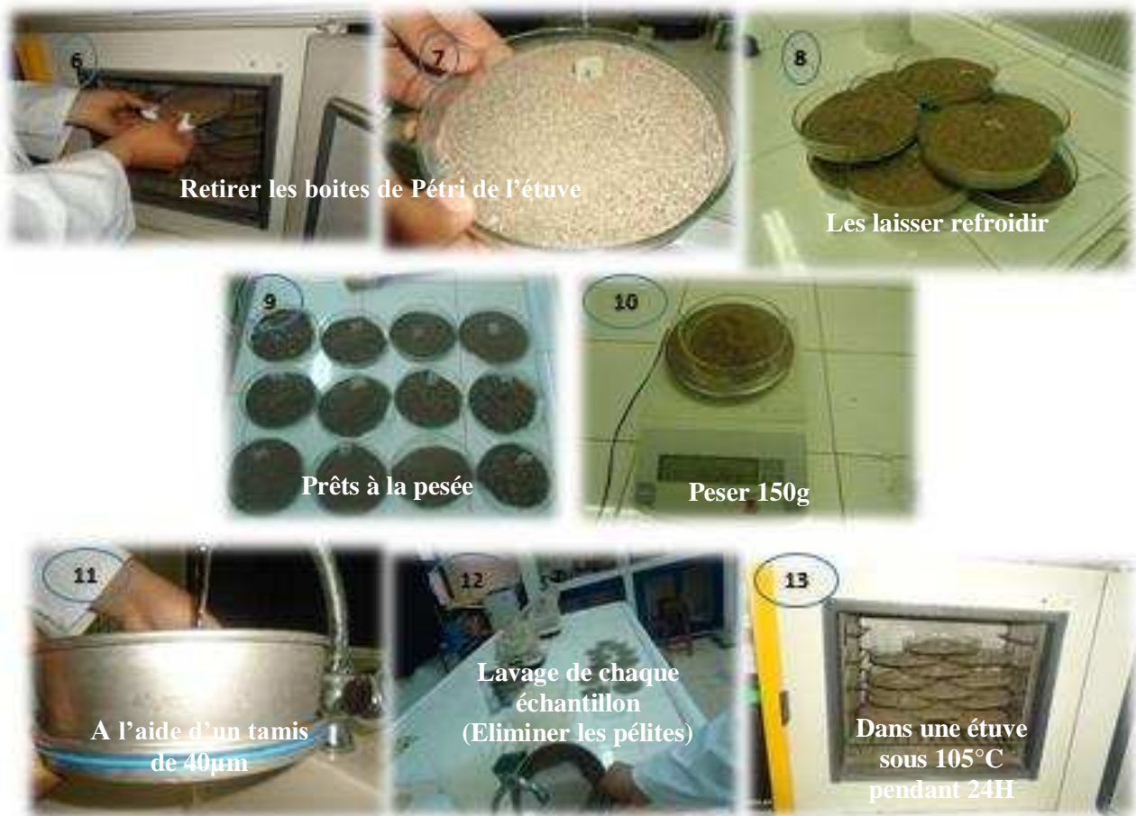
Photo 16 : Pesée et lavage des sédiments
