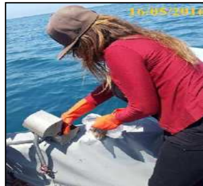
Photos n°9 : Prélèvement à l'aide de la benne Van Veen
