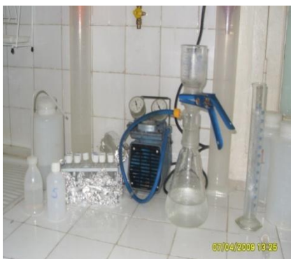
Figure7 : une pompe sous vide.
