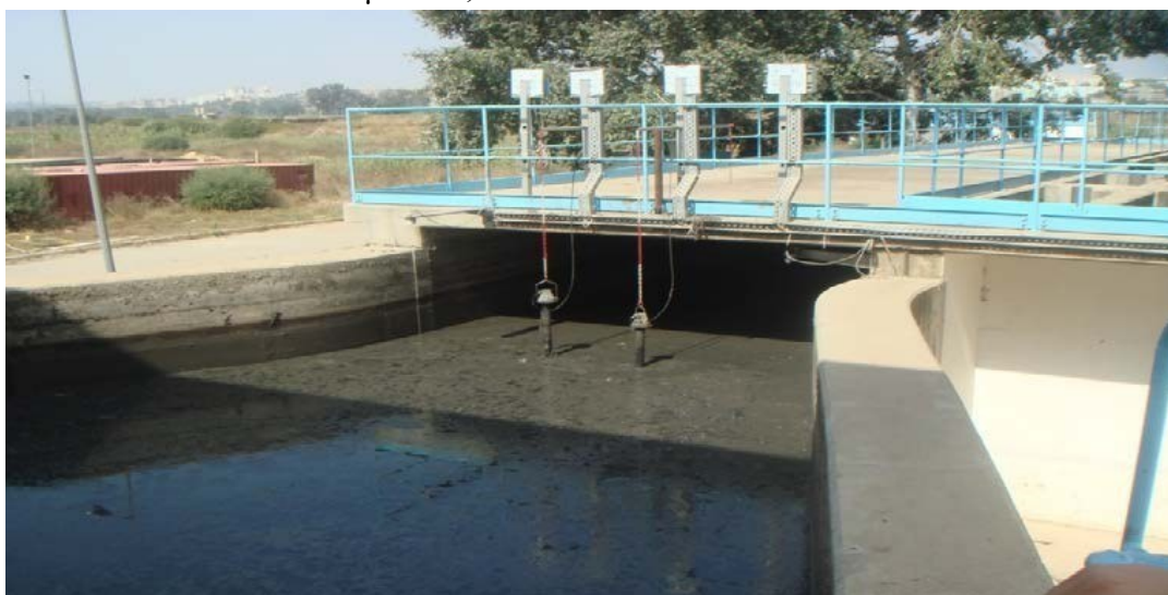
Figure 9. Mesures simultanées de pH, température, conductivité et hydrocarbures (17 avril 2025)
