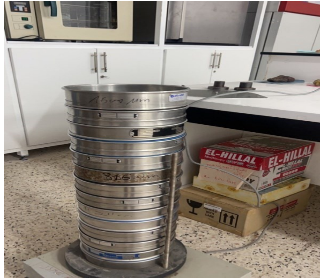
Figure 38. Le dispositif de tamisage des sédiments (Tamiseuse électrique).
