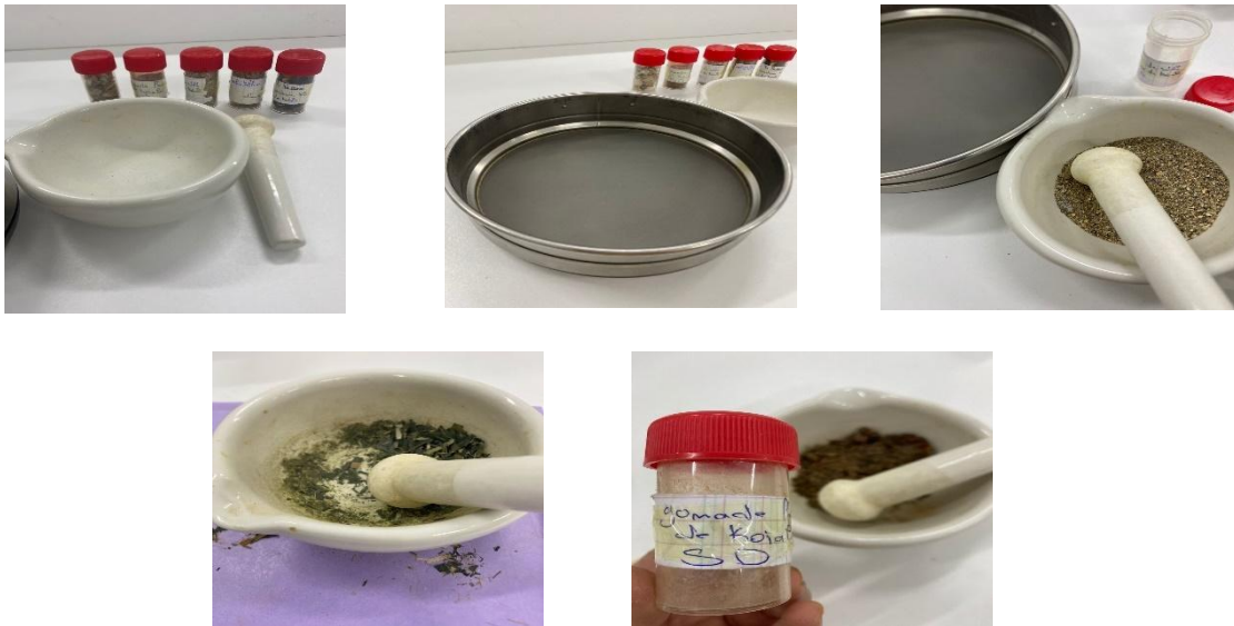
Figure 2.10: Illustration des étapes de broyage et de tamisage des sédiments, ainsi que du broyage de la matière biologique.
