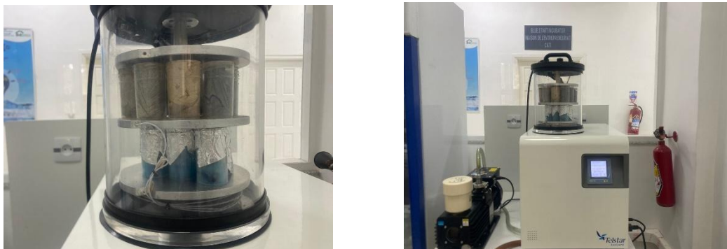
Figure 2.9: illustration des Échantillons en cours de lyophilisation dans l'appareil.
