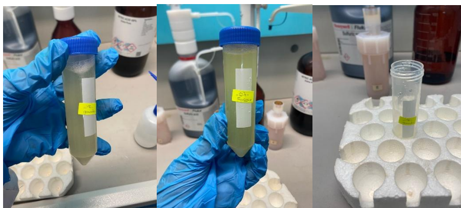
Figure 2.13 : Illustrations de l'étape de minéralisation acide appliquée aux échantillons en vue de leur préparation à l'analyse.
