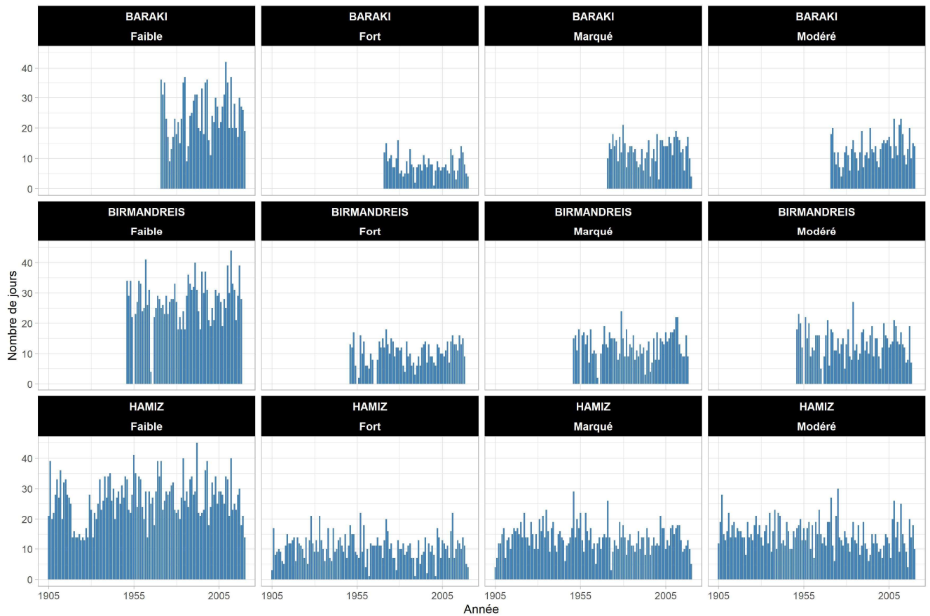
Figure 34: Nombre de jours par types de pluies de 1905 à 2005 pour les trois stations météorologiques : El Hamiz, Baraki et Birmandreis
