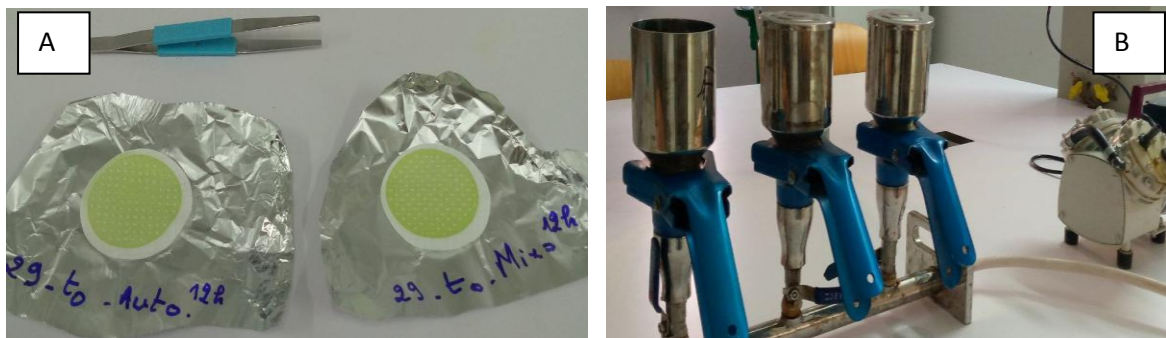
Figure II-21: Filtration algale ; (A) Membrane filtrante, (B) : Rampe de filtration.
