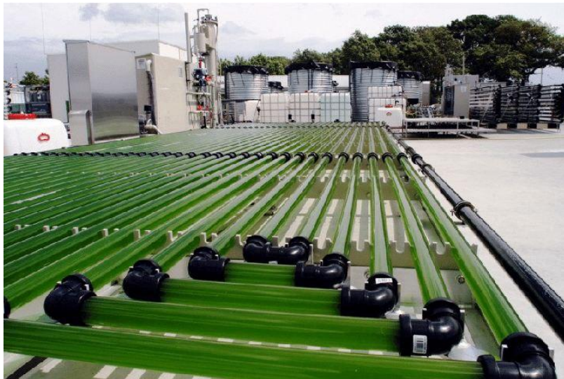
Figure I-4 : Photobioréacteur tubulaire horizontale https://www.wur.nl/en/Value-CreatioCooperation/AlgaePARC.htm
