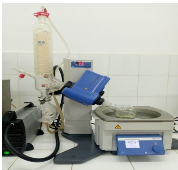
Figure II-26 : Rota vapeur (Buchi, R-300) au niveau de laboratoire LBCM.
