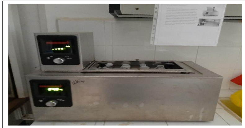
Figure VIII.14 : Agitateur muni d'un bain thermostaté (modèle Memmert SV 1422).
