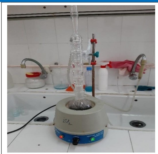
Figure VII.11 : Dispositif pour l'activation à l'acide chlorhydrique.
