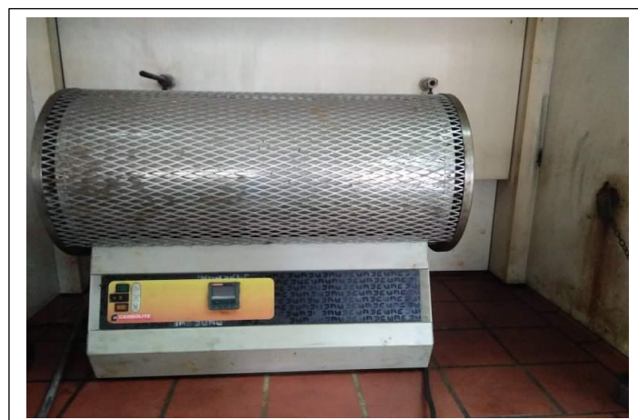
Figure VII.10 : Carbonisation physique dans le four tubulaire sous jet d'azote.
