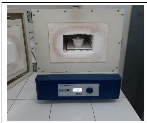
Figure VII.12 : Carbonisation physique dans le four à moufle
