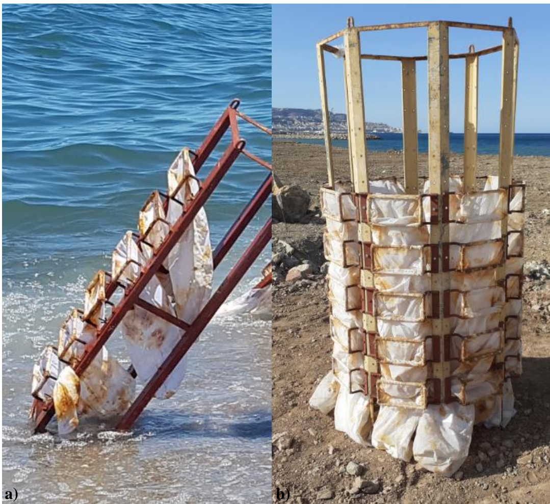
Figure II.5 : Les pièges à sédiments : a) unidirectionnels, b) multidirectionnels
