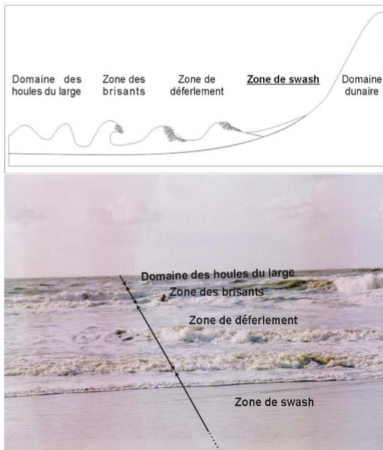
Figure I.10 : Zonation hydrodynamique du littoral (Degryse-Kulkarni, 2003).
