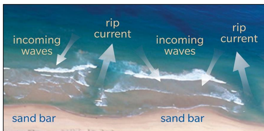
Figure I.14 : Schéma du courant d'arrachement rip current induit par les variations longitudinales du déferlement des vagues (Bearman and Brown, 1999).
