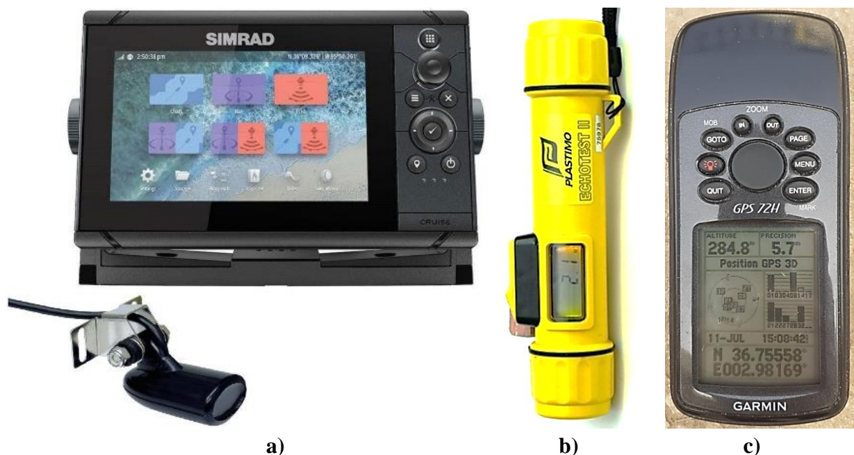
Figure II.3 : Les instruments de mesures : a) Simrad Cruise 7 , b) Plastimo Echotest II et c) GPS Garmin 72H
