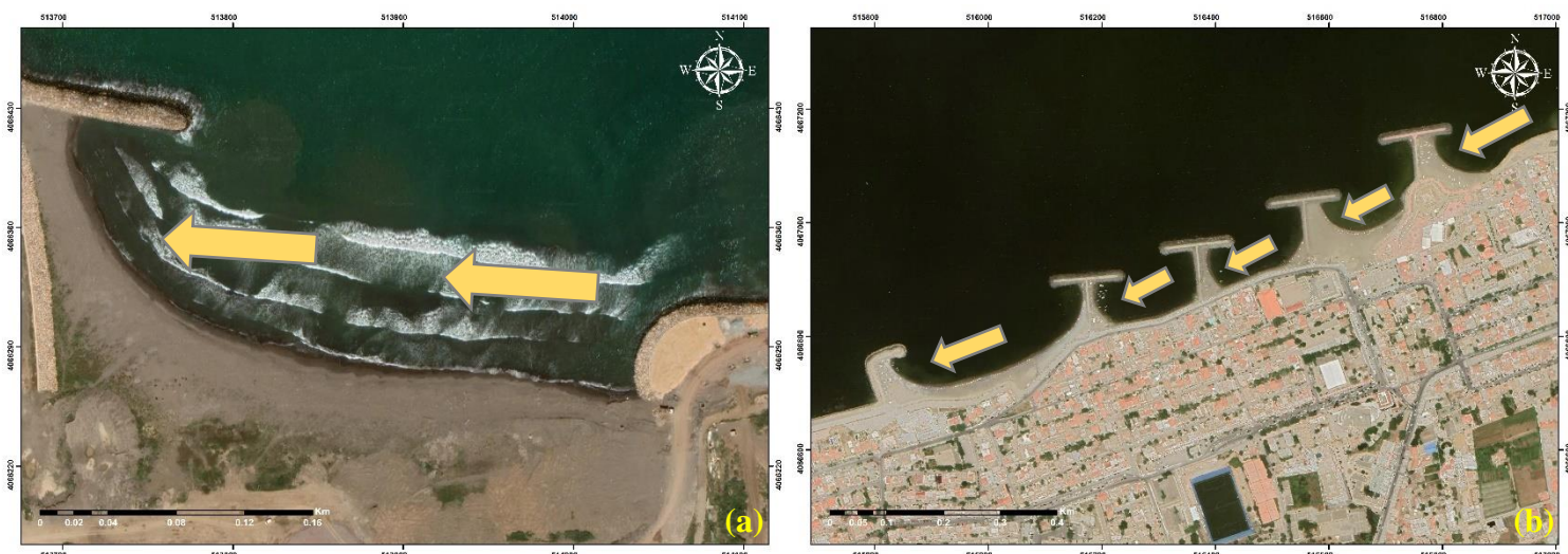
Figure IV.8 : Images satellitaire récente (2022) des plages de : a) Mazela et b) Sirène II . Les flèches jaunes décrivent la direction du transport sédimentaire longitudinal.
