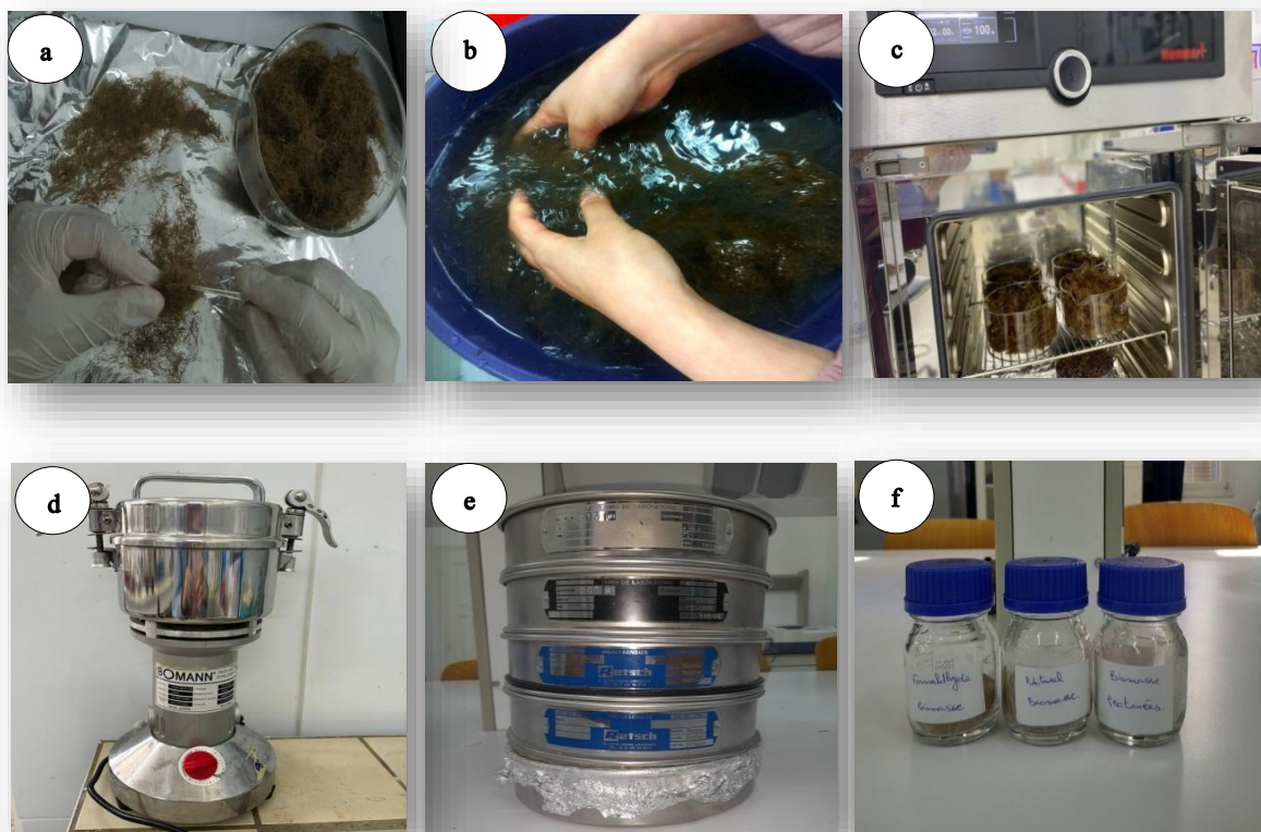
Figure 10: Prétraitement de la biomasse a : effilochage b : rinçage des fibres c : séchage d : broyage e : tamisage f : stockage.
