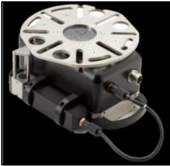
Fig. III.1 : Transducteur immergeable avec célérimètre de coque
