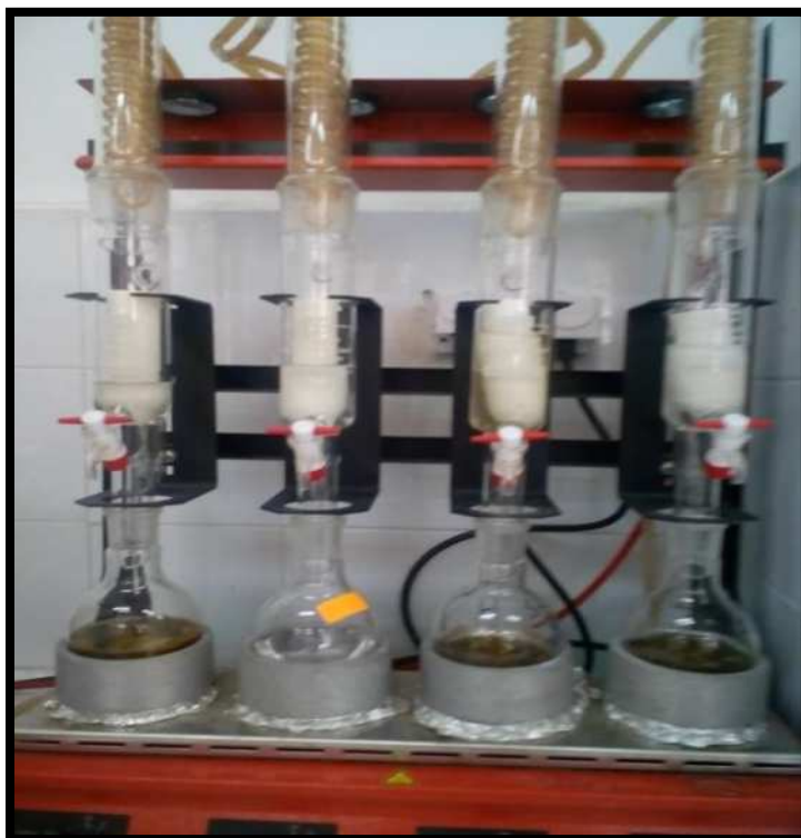
Figure III.11 : photo d'un extracteur Soxhlet.
