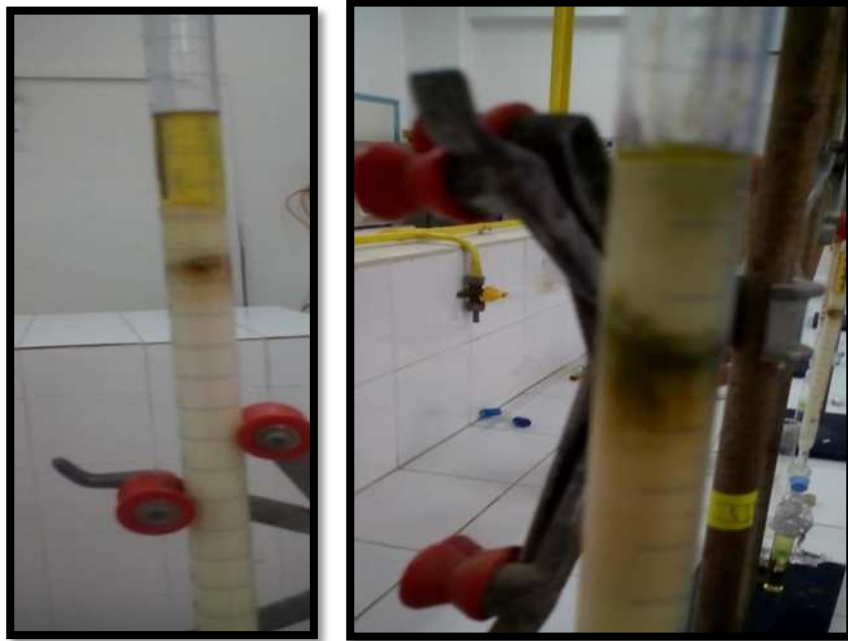
Figure III.12 : purification et fractionnement par chromatographie sur colonne ouverte.
