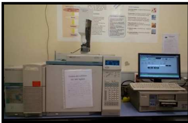
Figure III.15: La chromatographie en phase gazeuse couplée à la spectrométrie de masse (GC-MS) (CRAPC).
