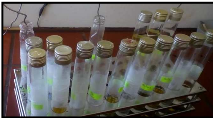
Figure III.13 : Concentration sous-jet d'azote.
