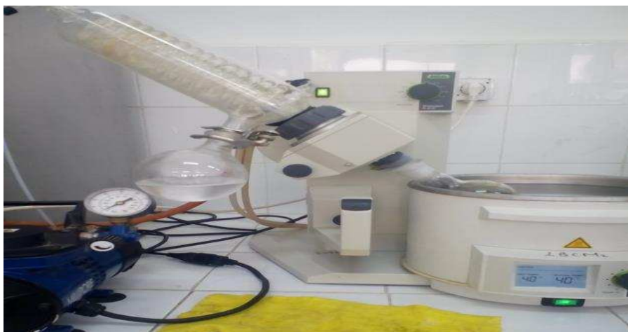
Figure 5: Concentration des extraits à l'aide d'un évaporateur rotatif.
