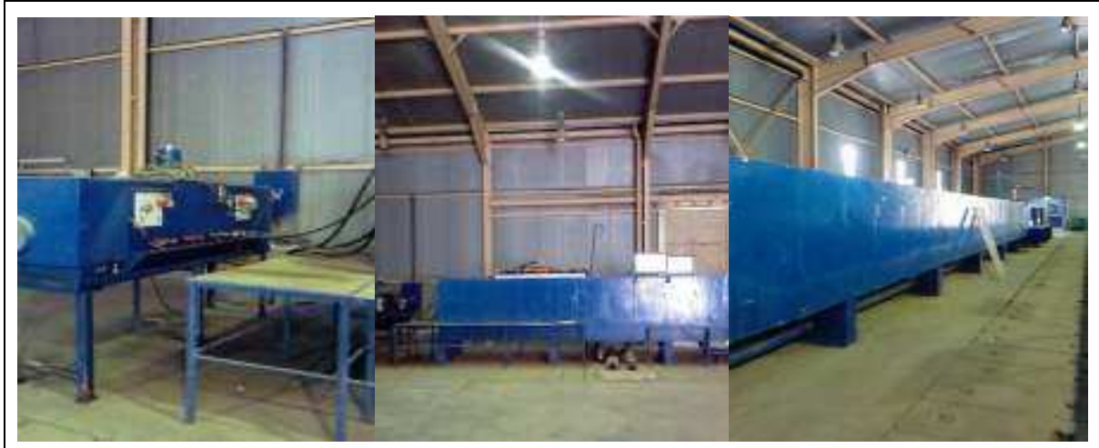
Figure VI.4 : Canal à houle, dispositif mécanique de génération des houles, laboratoire du LEM.
