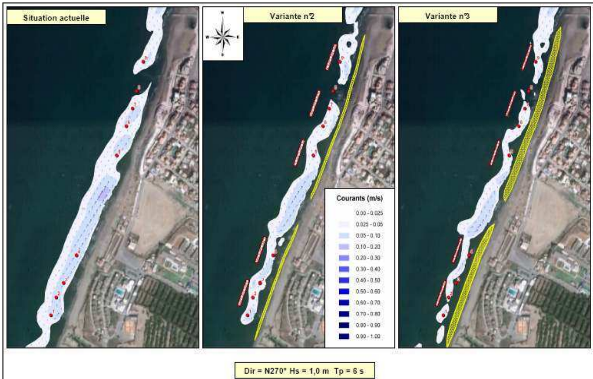
Figure 11: Comparaison des variantes de protection de Palm Beach par Mopla, Courants pour le cas H1.
