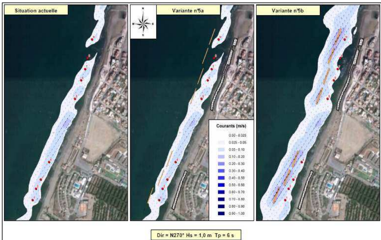
Figure 12 : Comparaison des variantes de protection de Palm Beach par Mopla, Courants pour le cas H1.
