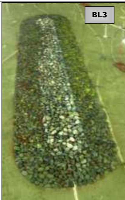
Photos n° 17 : Etat des ouvrages après les essais de la série progressive (niv. \pm 0.00 ) et d'endurance (niv. +1.0m NGA).
