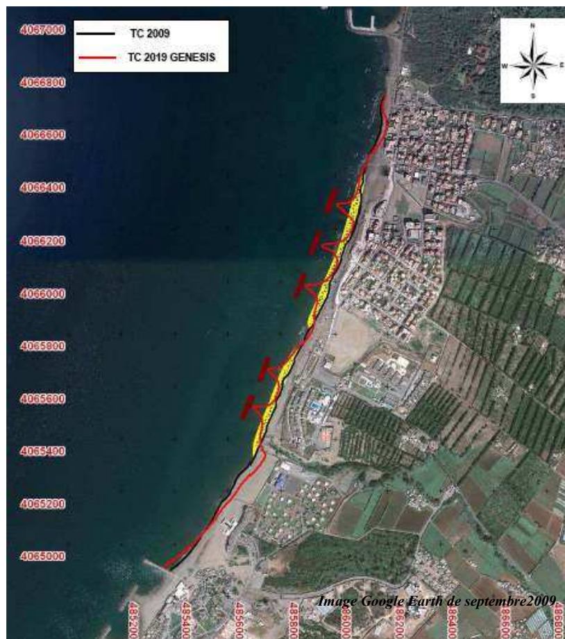
Figure V.25 : Position du trait de côte évalué par Genesis sur 10 ans (2009 nature - 2019 modèle), variante n°3 de protection de Palm Beach. (SGH, 2010)
