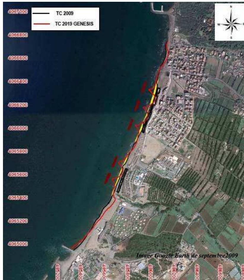
Figure V.27 : Position du trait de côte évalué par Genesis sur 10 ans (2009 nature - 2019 modèle), variante n°4 de protection de Palm Beach. (SGH, 2010)
