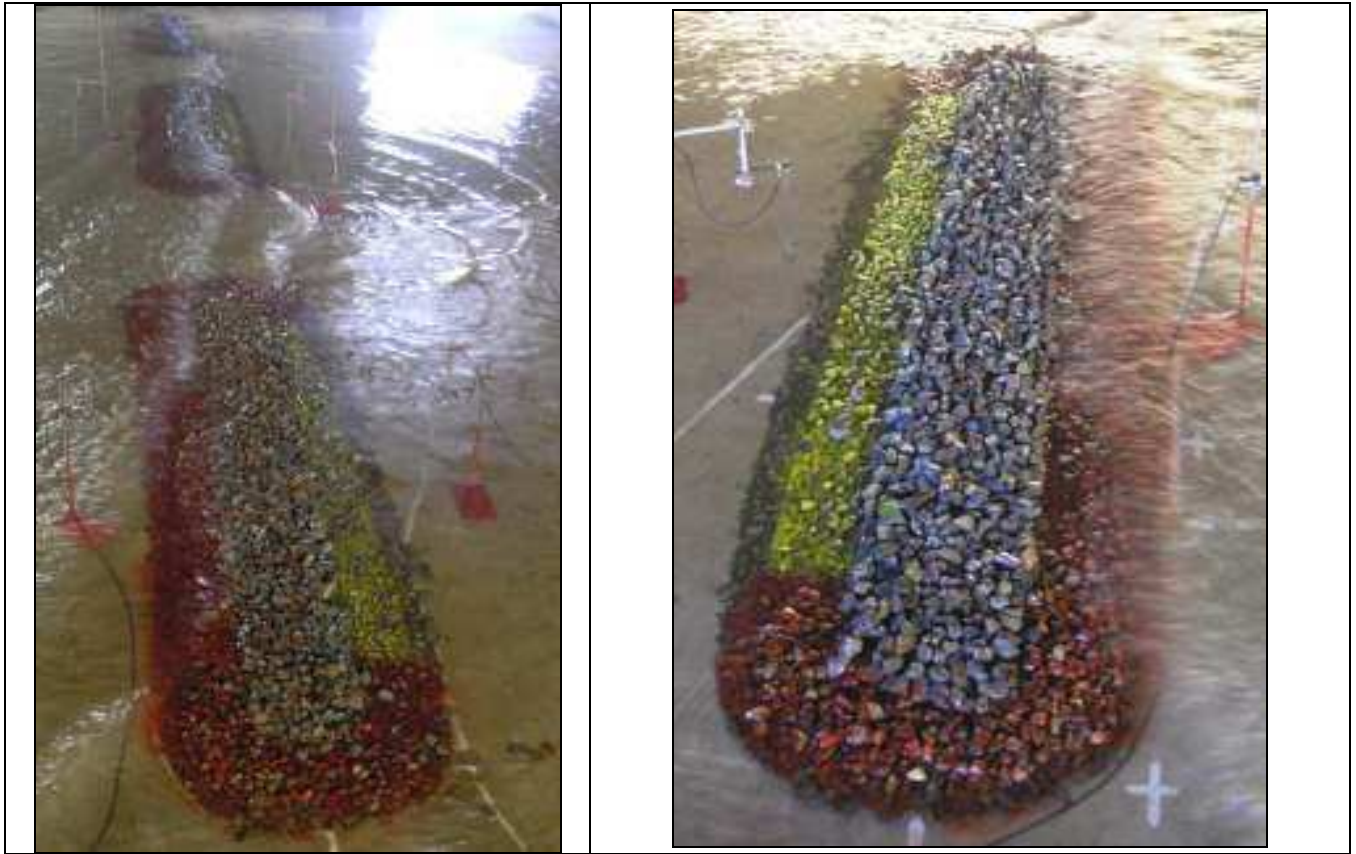
Photos n° 5 : Déferlement de la houle sur les brise-lames – niveau -0.5m NGA.
