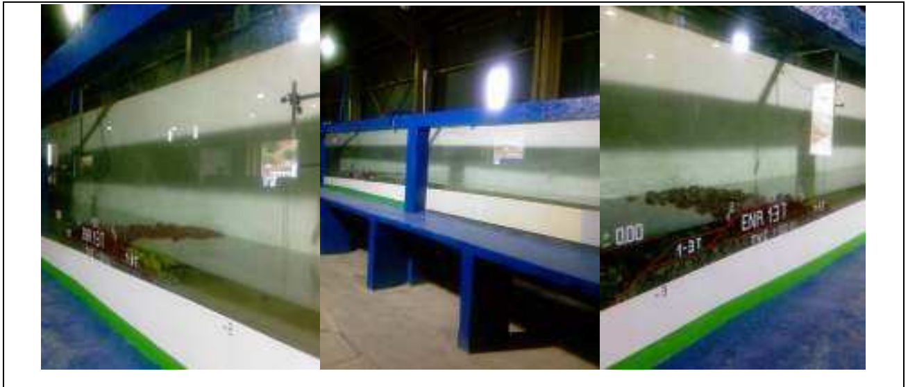
Figure VI.3 : Pose de la maquette du brise-lames dans le canal et remplissage en eau, laboratoire du LEM.
