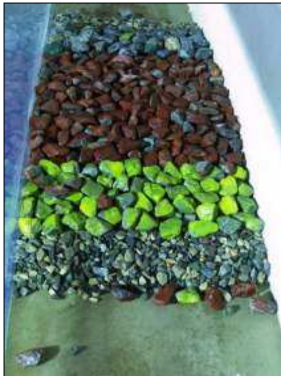
Photo n° 29 : Vue de l'ouvrage du côté intérieur après les essais avec un niveau -0.5m NGA Pas d'évolution des dégâts.
