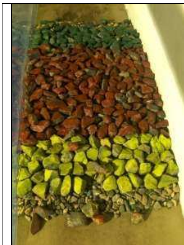
Photo n° 7 : Etat de la contrebutée intérieure après essais.
