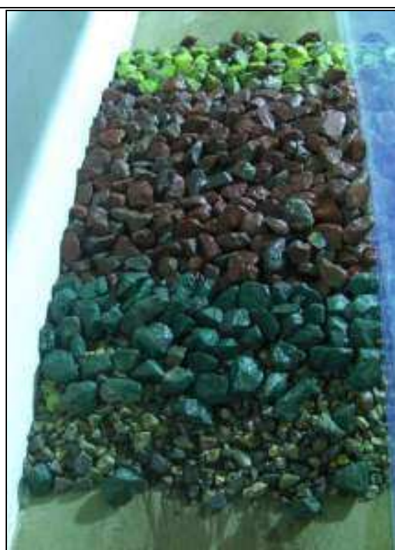
Photo n° 8 : Etat de la contrebutée extérieure après essais.
