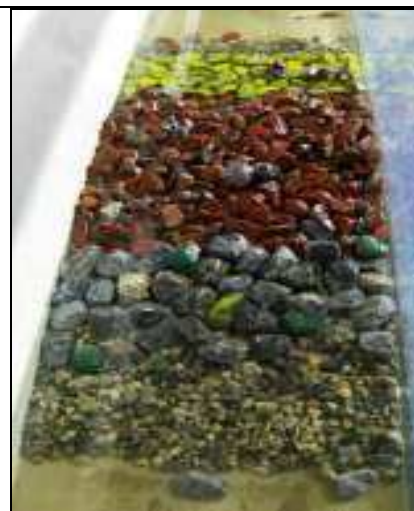
Photo n° 27 : Vue du côté extérieur du brise-lames après l'essai d'endurance (niv. +0.5m NGA).
