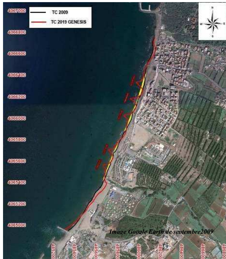
Figure V.23 : Position du trait de côte évalué par Genesis en m/an sur 10 ans (2009 nature -2019 modèle), variante n°2 de protection de Palm Beach. (SGH, 2010)
