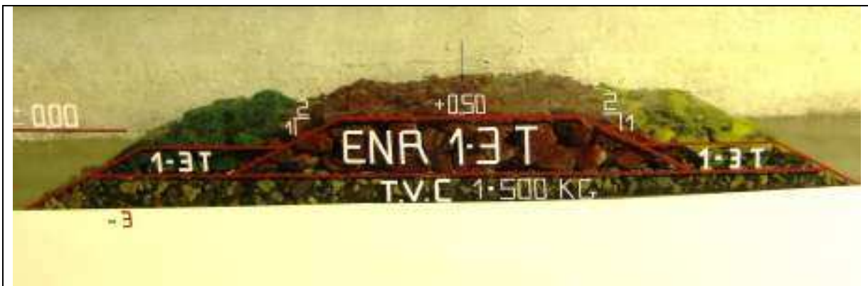
Photo n° 1 : Profil initial avant essais.
