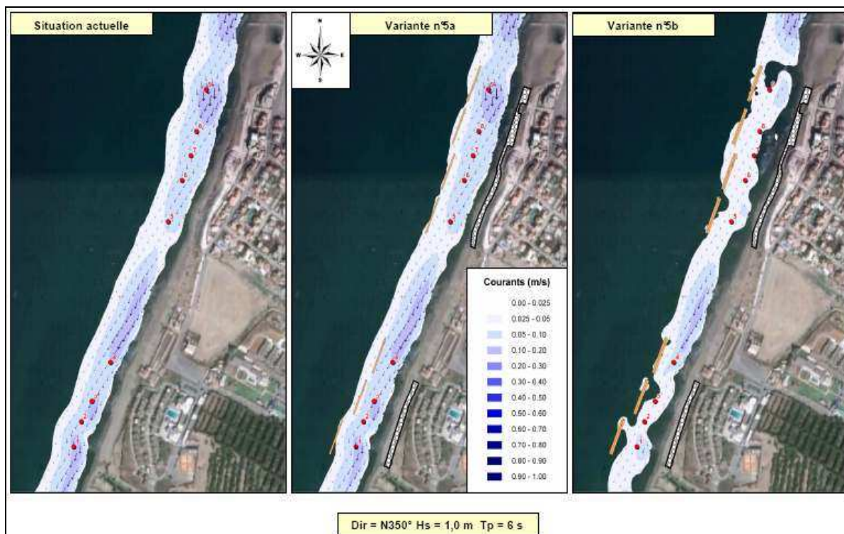
Figure 16 : Comparaison des variantes de protection de Palm Beach par Mopla, Courants pour le cas H3.
