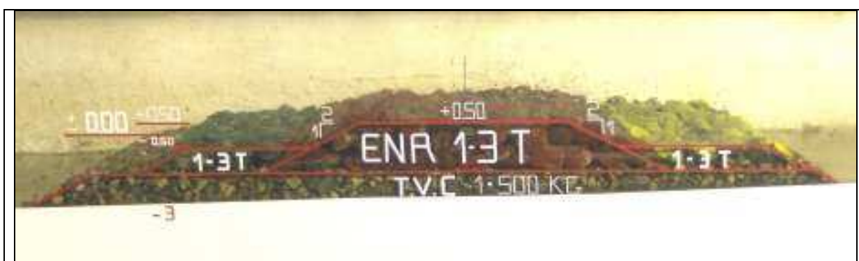
Photo n° 12 : Profil de la variante initiale bis avant essais.
