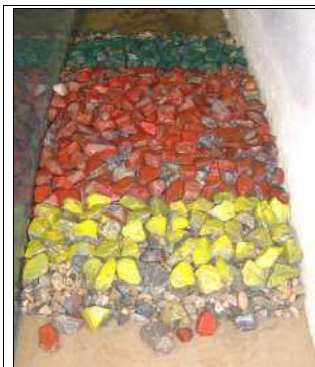
Photo n° 10 : Pas d'évolution de l'état de stabilité de la contre butée intérieure après les essais avec niveau d'eau à -0.5m.
