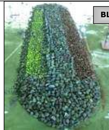
Photos n° 17 : Etat des ouvrages après les essais de la série progressive (niv. \pm 0.00 ) et d'endurance (niv. +1.0m NGA).
