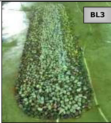
Photos n° 20 : Etat des ouvrages après les essais de la série progressive (niv. \pm 0.00 ) et d'endurance (niv. +1.0m NGA).
