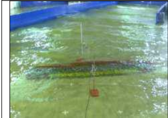
Photo n° 7 : Mode d'attaque de la houle sur les ouvrages.
