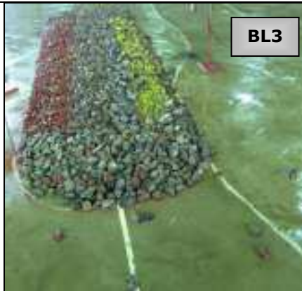
Photos n° 17 : Etat des ouvrages après les essais de la série progressive (niv. \pm 0.00 ) et d'endurance (niv. +1.0m NGA).
