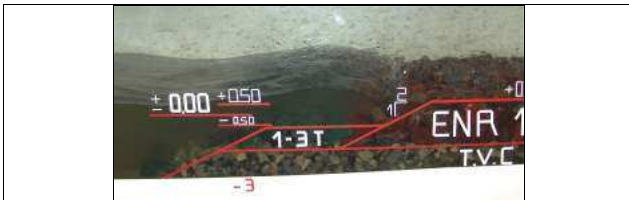
Photo n° 9 : Point d'impact de la houle sur l'ouvrage pendant l'essai les essais avec niveau -0.5m NGA.
