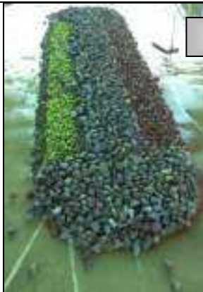
Photos n° 17 : Etat des ouvrages après les essais de la série progressive (niv. \pm 0.00 ) et d'endurance (niv. +1.0m NGA).
