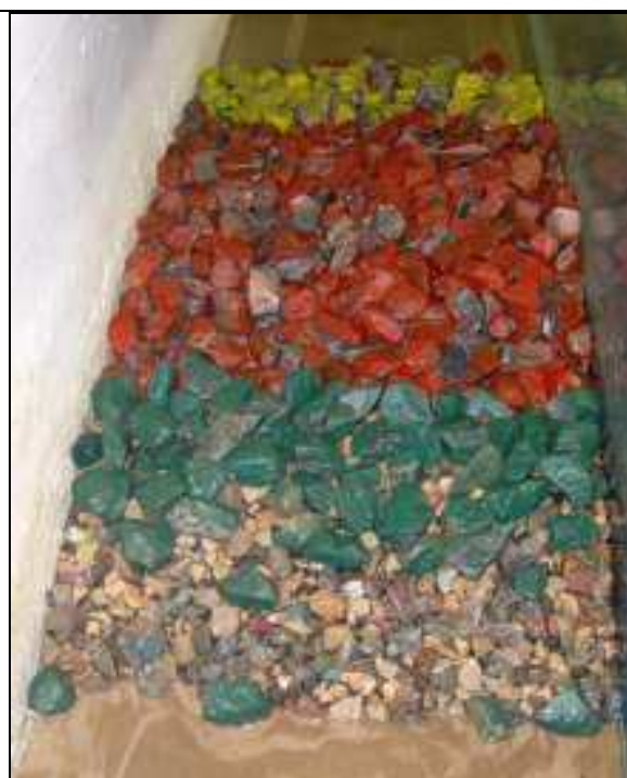
Photo n° 11 : Pas d'évolution de l'état de stabilité de la contre butée extérieure après les essais avec niveau d'eau à -0.5m.
