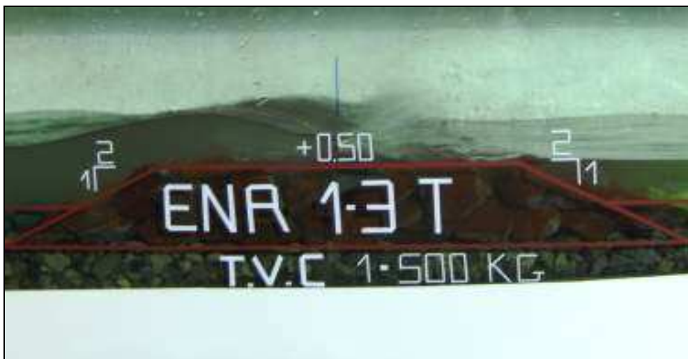
Photo n° 4 : Déferlement de la houle sur la berme supérieure de l'ouvrage.
