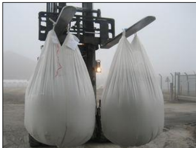
Figure 70 : Photographie d'un big-bag indiquant son point de levage ( glossaire-international.com )
