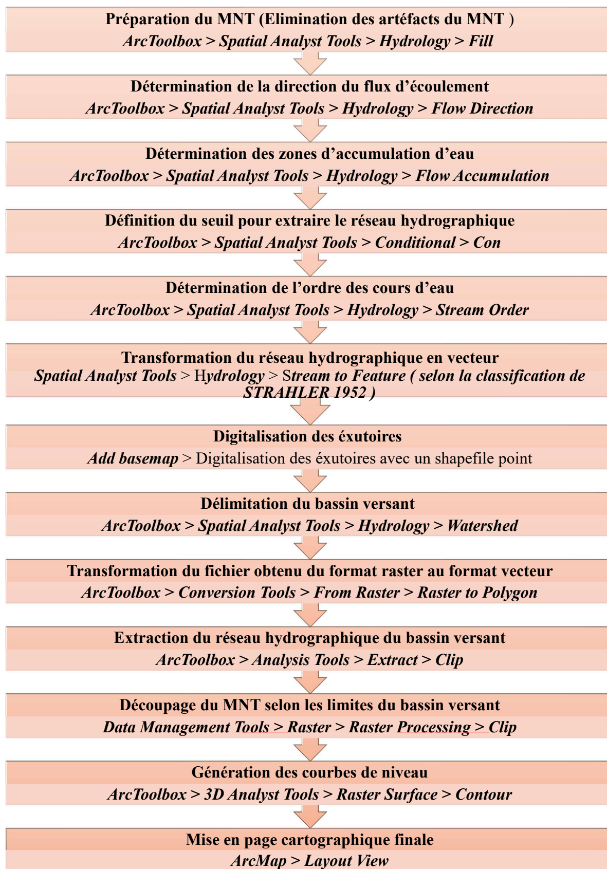
Figure 8 : Schéma des étapes de réalisation de la carte topographique et hydrographique du bassin versant de Réghaia avec les communes limitrophes
