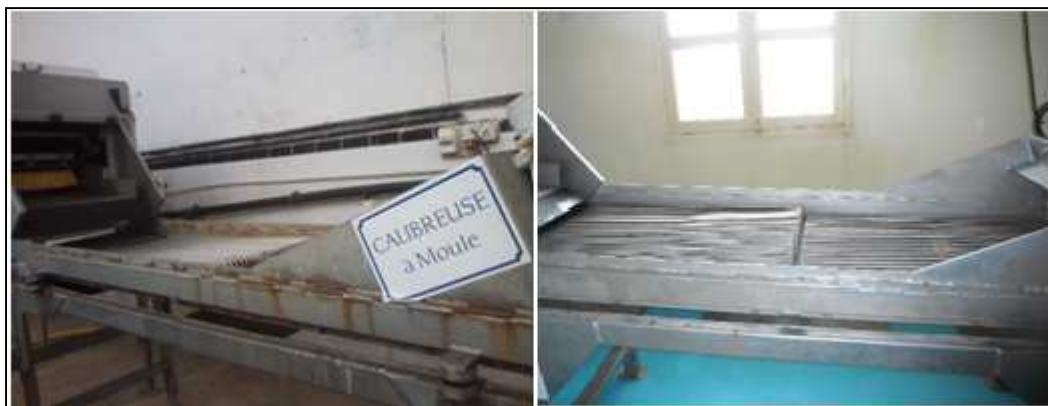
Figure 44 : Calibreuse à moule (ferme d'EAM)
