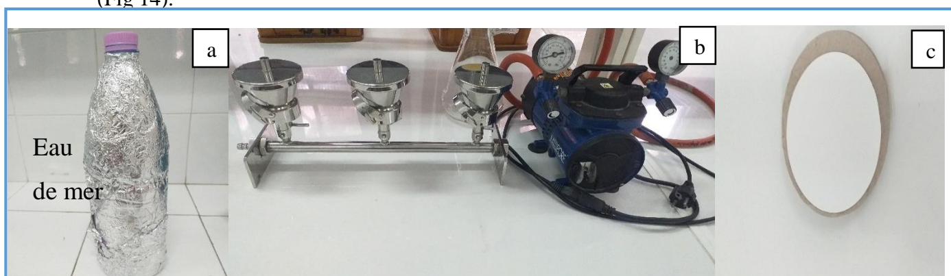
Figure 14: Matériels pour la détermination de la chlorophylle (a) : (a : membrane de filtration, b : rampe de filtration, c : bouteille recouverte de papier aluminium).
