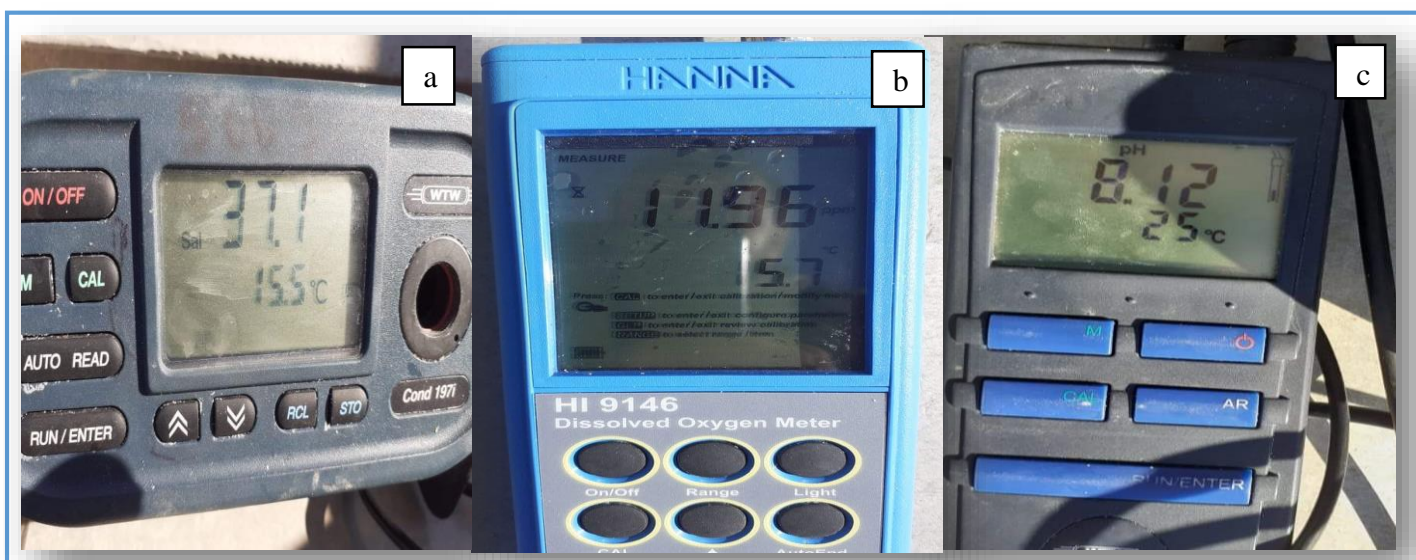
Figure 13: Instruments de mesure des paramètres physico-chimiques (a : thermo-salinomètre, b : oxymètre, c : pH mètre).
