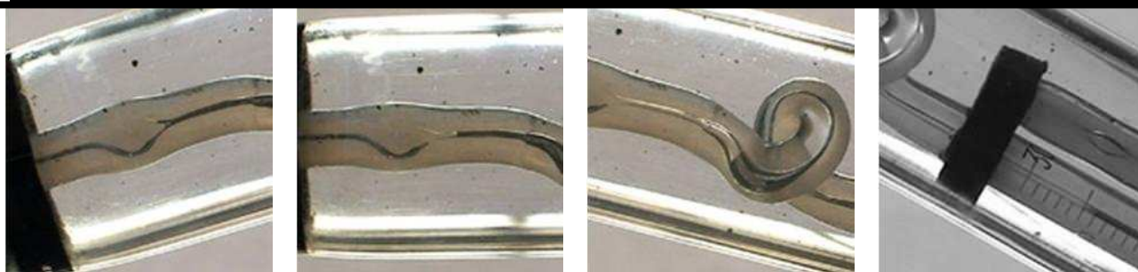
Figure6 : La rupture de la colonne du mercure au cours du renversement.
