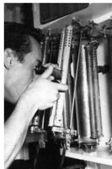
Figure7 : Lecture du thermomètre à renversement (Photo IRD)
